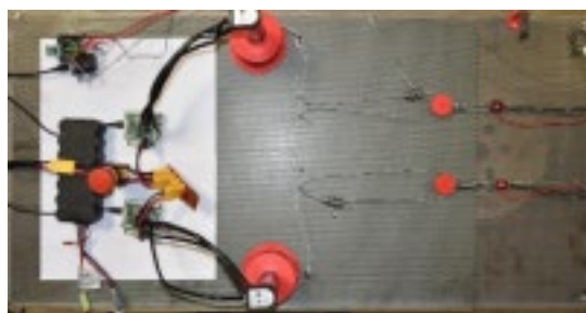
Figura 3. Montaje Mecánica Sencilla para Sinergias con los Encoders, Células de Carga y Sensor de Desplazamiento Lineal
